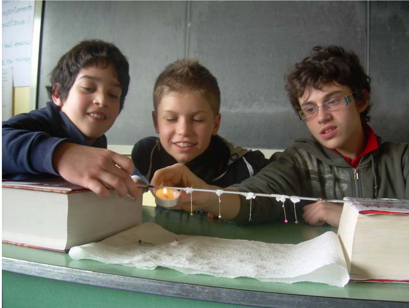
Foto n. 2 Accensione delle candele ad una estremità del ferro e caduta progressiva degli spilli
